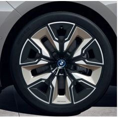
21인치 인디비주얼 에어로다이내믹 910 멀티스플러 티타늄 브론즈 3D 휠 휠 및 타이어 사이즈 (앞) 9J x 21 255/40 R21 휠 및 타이어 사이즈 (뒤) 10.5J x 21 285/35 R21.
