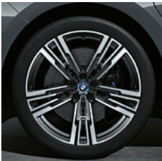
21인치 M 라이트 알로이 908 M 바이컬러 체트 블랙 휠 휠 및 타이어 사이즈 (앞) 9J x 21 255/40 R21 휠 및 타이어 사이즈 (뒤) 10.5J x 21 285/35 R21.
